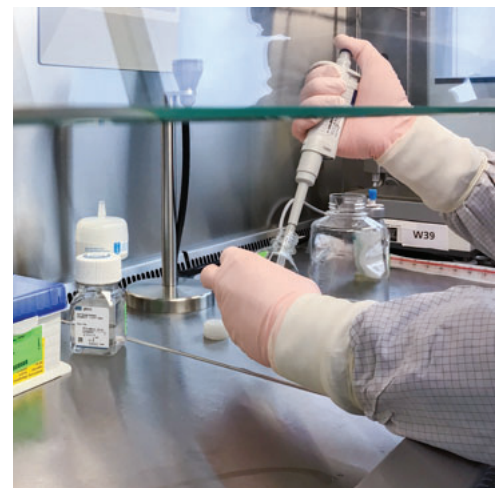
Vorbereitungsarbeiten für die Herstellung in Reinraumklasse A.
